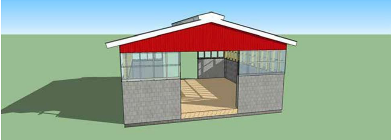
Bild 13. Exempel på dagsljusinsläpp, med ljusgenomsläppligt material i väggar, på en ligghall med sadeltakskonstruktion.
